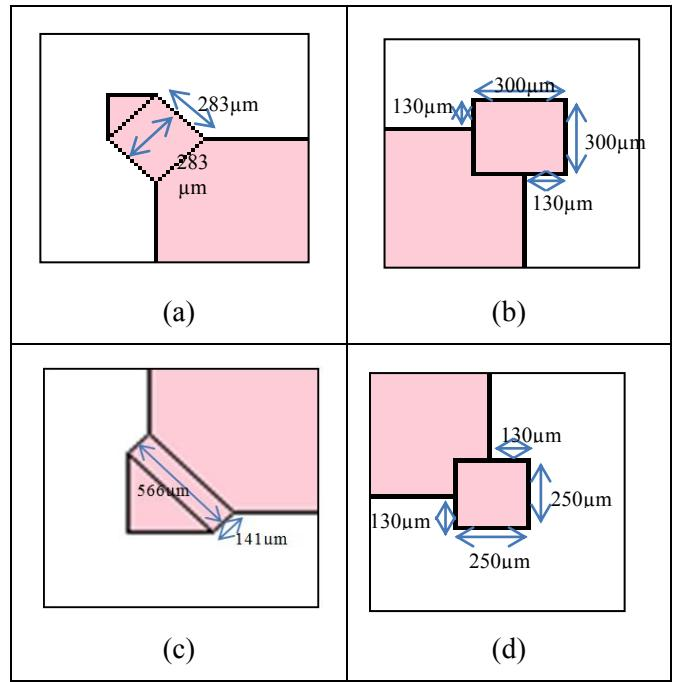
Fig. 2. Corner compensation structures (a) corner (b) square 1 (c) triangle (d) square 2.
